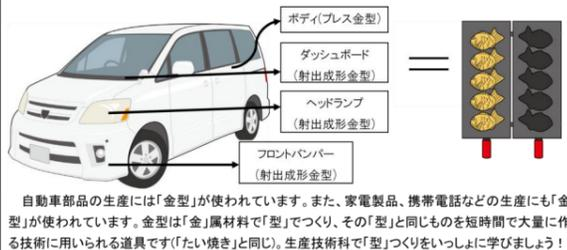
自動車部品の生産には「金型」が使われています。また、家電製品、携帯電話などの生産にも「金型」が使われています。金型は「金」属材料で「型」で作り、その「型」と同じものを短時間で大量に作る技術に用いられる道具です(「たい焼き」と同じ)。生産技術科で「型」づくりをいっしょに学びましょう！
